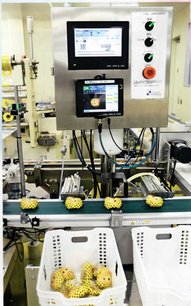
AI技術でどじょう掬いまんじゅうの不良品を識別する装置 II松江市東出雲町錦浜 中浦食品松江工場
